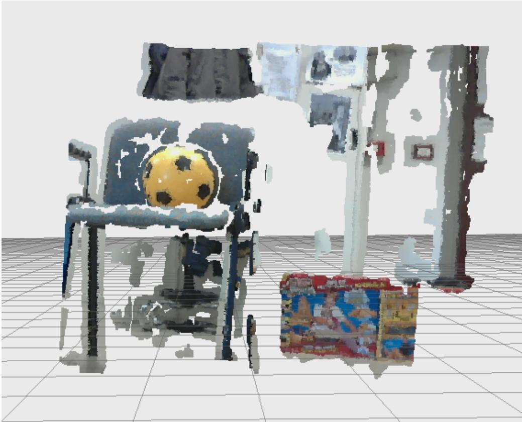
Figura 4.2: Point cloud ottenuta dal nodo di acquisizione di visione stereo.
