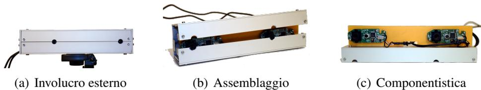
Figura 2.4: La testa stereo utilizzata.
