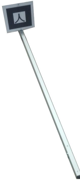
Figura 2.5: Staffa per l'autocalibrazione.
